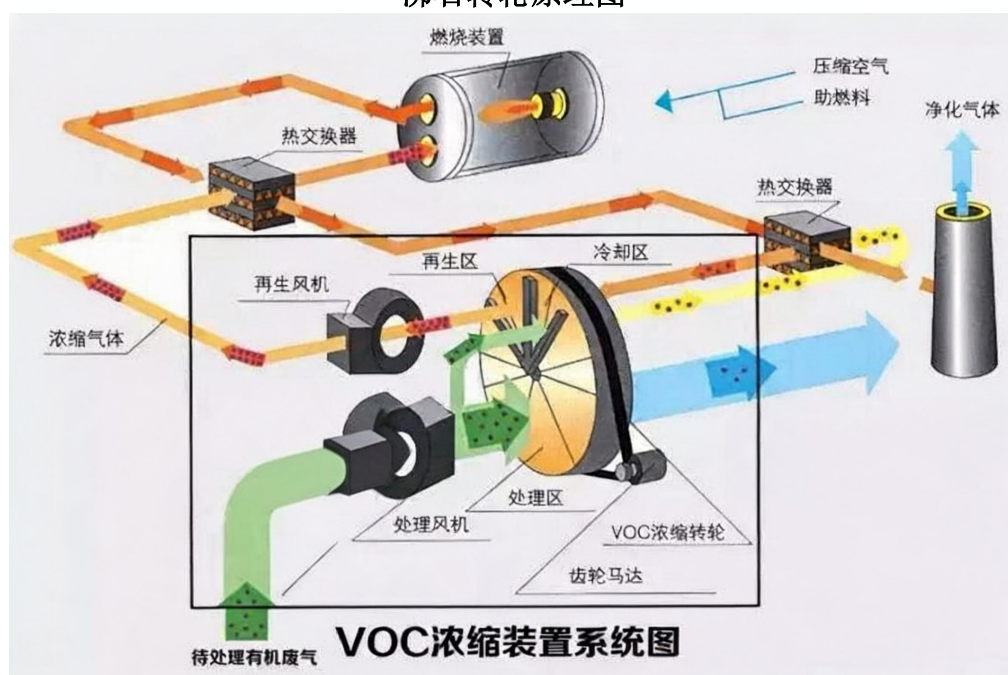
图 4-2 沸石转轮+CO 催化燃烧炉结构图
